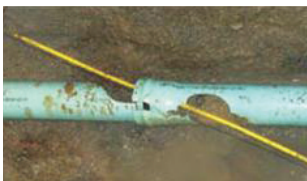
Líneas de servicio que han sido penetradas durante una instalación sin zanjado.
