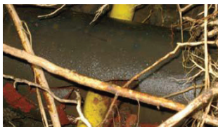
Líneas de servicio que han sido penetradas durante una instalación sin zanjado.
